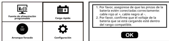
1. Por favor, asegúrese de que las pinzas de la batería estén conectadas correctamente: cable rojo al +, cable negro al -.
