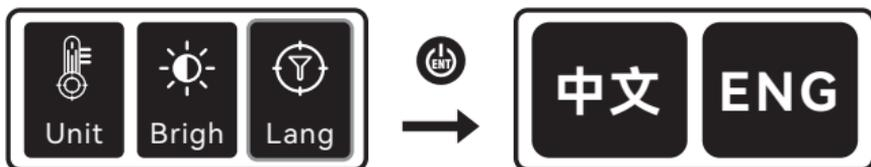
Verwenden Sie die **Umschalt-Taste**, um zwischen verschiedenen Sprachen zu wechseln, und drücken Sie die **Eingabetaste**, um die Sprache auszuwählen und zu speichern. Nach Abschluss der Einstellung kehrt das Display automatisch zur Hauptoberfläche zurück.
