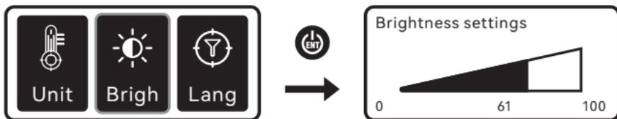
Durch Drücken der **Eingabetaste** kann die Hintergrundbeleuchtung angepasst werden, während ein langes Drücken der **Eingabetaste** eine schnelle Anpassung ermöglicht. Sobald die Anpassung abgeschlossen ist, speichert das Drücken der **Umschalt-Taste** die Einstellungen und verlässt die Helligkeitseinstellungen, wobei automatisch zur Hauptoberfläche zurückgekehrt wird.
