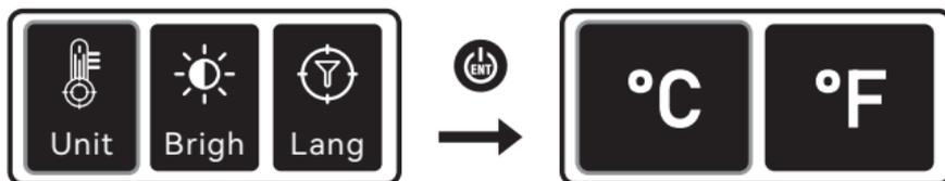
Die Benutzer können die **Umschalt-Taste** verwenden, um die gewünschte Einheit auszuwählen, und anschließend die **Eingabetaste** drücken, um zu speichern. Nach dem Speichern wird direkt zur Hauptoberfläche zurückgekehrt.
